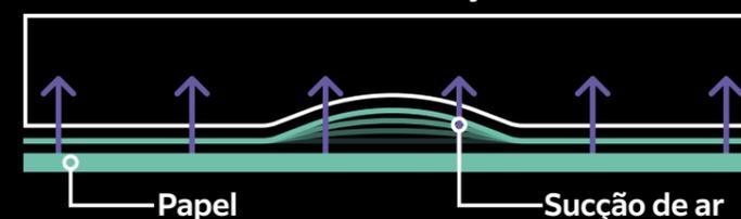
A cabeça vaivém extrai o papel com força com recurso a uma pequena quantidade de ar, separando e fornecendo cada folha de forma fiável. A cabeça ativa evita a fricção na superfície do papel, o que pode constituir um problema com outras tecnologias de alimentação por sucção.
