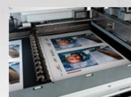
Le système de séchage se compose d'une courroie de transport chauffée par le biais de rouleaux. Une aspiration est également appliquée à la feuille lorsqu'elle traverse cette section. Le séchage s'effectue via un mécanisme double combinant la courroie chauffée et l'air chaud diffusé par le haut. L'aspiration garantit une application uniforme de la chaleur, ce qui assure la stabilité de la feuille et optimise le processus de séchage.
