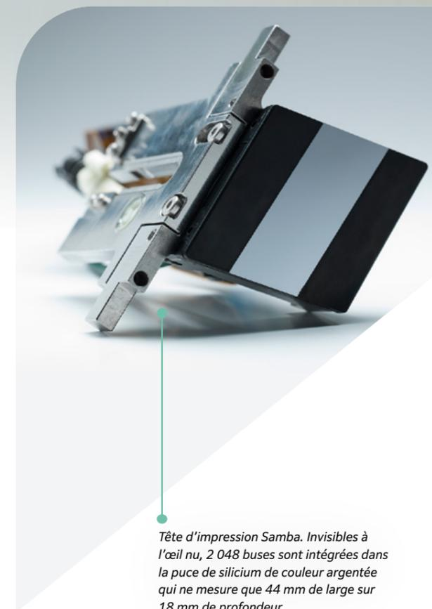
*Tête d'impression Samba. Invisibles à l'œil nu, 2 048 buses sont intégrées dans la puce de silicium de couleur argentée qui ne mesure que 44 mm de large sur 18 mm de profondeur.*
