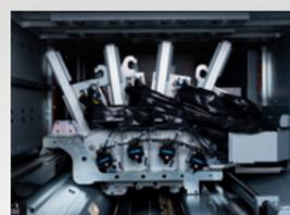
Le papier est chargé sur le cylindre d'écriture sur lequel il est maintenu à l'aide de pinces et d'une aspiration. Quatre barres d'impression Samba déposent les encres CMJN en un seul passage. Le système d'aspiration unique améliore sensiblement la constance et la qualité d'impression.
