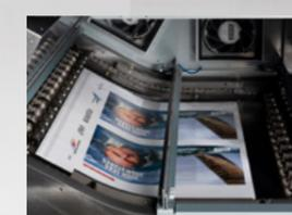
Avant leur sortie de la presse, les feuilles passent par une batterie de ventilateurs pour atteindre la température idéale et optimiser le séchage de l'encre.
