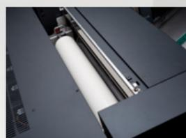
L'unité de couchage applique un film ultra fin d'apprêt RCP (Rapid Coagulation Primer) sur la feuille via un rouleau anilox (en mode Qualité supérieure). L'association de la couche d'apprêt avec l'encre aqueuse produit des points d'une très grande précision et des images éclatantes sur un papier couché standard B2.
