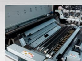
Toutes les impressions sont scannées par le système ILS (In-Line Sensor) qui effectue les modifications nécessaires en temps réel. Le système est monté juste après l'impression afin de garantir l'application dynamique des ajustements tout au long du tirage.
