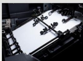
Pour la réalisation d'applications recto verso avec données variables, un code-barres est imprimé en dehors d'un format d'image sur chaque feuille. Lors de l'impression du verso, la presse lit le code-barres et télécharge les données correspondantes pour cette feuille avant de procéder à l'impression.
