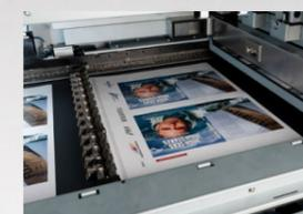
El sistema de secado cuenta con una cinta transportadora calentada por rodillos, aplicando vacío a la hoja al pasar por esta sección. El secado se realiza aplicando calor desde arriba a través de la cinta calentada. El vacío garantiza la aplicación del calor de forma uniforme, mantiene la hoja estable y optimiza el proceso de secado.
