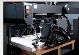
Un mecanismo tradicional de alimentación del papel garantiza una alta precisión de registro y un funcionamiento fiable.
