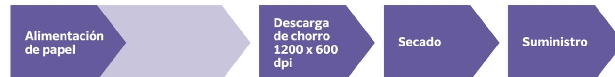
El modo de Alto rendimiento ahorra el uso de la imprimación (RCP) y reduce el consumo de tinta con una resolución de 1200 x 600 ppp
