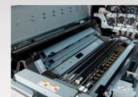
El sistema In-Line Sensor (ILS) escanea todos los pliegos y efectúa las modificaciones necesarias en tiempo real. El sistema se monta justo después de la impresión para garantizar que los ajustes se apliquen dinámicamente durante toda la tirada.
