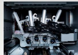
El papel se alimenta en el cilindro de formación de imágenes donde está sujeto por pinzas y vacío, y cuatro barras de impresión Samba depositan las tintas CMYK en una sola pasada. El exclusivo sistema de vacío mejora significativamente la consistencia y la calidad de la impresión.
