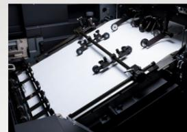
Para gestionar aplicaciones personalizadas a doble cara, se imprime un código de barras fuera de la zona de imagen de cada pliego. Al voltear la hoja, se escanea el código de barras y el equipo descarga los datos correspondientes a esa hoja antes de imprimir.
