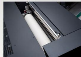
Esta unidad aplica una película ultrafina de Imprimación de Coagulación Rápida al papel mediante un rodillo anilox (en modo de Alta Calidad). La reacción de la imprimación y la tinta de base acuosa presenta unos puntos increíblemente definidos y unas imágenes brillantes en papel offset B2 estándar.
