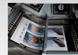
Antes de salir del equipo, el papel pasa por debajo de un conjunto de ventiladores diseñados para optimizar su temperatura y el secado de la tinta.
