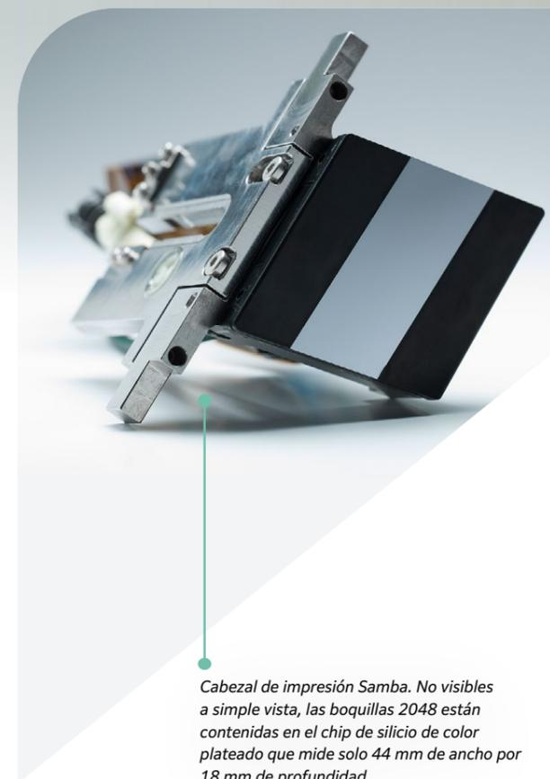
*Cabezal de impresión Samba. No visibles a simple vista, las boquillas 2048 están contenidas en el chip de silicio de color plateado que mide solo 44 mm de ancho por 18 mm de profundidad.*
