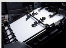
Um doppelseitige Druckanwendungen mit variablen Daten zu ermöglichen, wird ein Barcode am Rand von jedem Bogen gedruckt. Nach dem Wenden der Bogen wird der Barcode ausgelesen und das System lädt vor dem Drucken den entsprechenden Datensatz für diesen Bogen.
