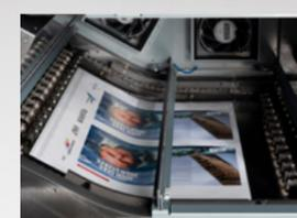
Bevor die Bogen die Druckmaschine verlassen, werden sie unter einer Gruppe von Ventilatoren entlang geführt, um die Bogentemperatur und Farbtrocknungsleistung zu optimieren.
