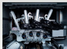
Das Papier wird auf den Druckzylinder übergeben, wo es von Greifern und einem Vakuum gehalten wird und die vier Samba-Druckköpfe die CMYK-Tinten in einem Durchlauf auftragen. Das einzigartige Vakuumssystem verbessert die Druckqualität und Einheitlichkeit erheblich.
