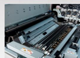
Jeder einzelne Bogen wird mit dem ILS-System gescannt und nötige Anpassungen werden in Echtzeit vorgenommen. Das System ist direkt nach dem Druckzylinder positioniert, um sicherzustellen, dass alle nötigen Anpassungen dynamisch während des Betriebs erfolgen.
