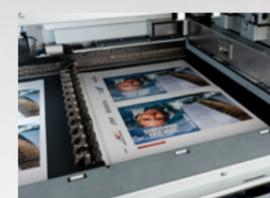
Bei dem Trocknungssystem werden die bedruckten Bogen per Luftansaugung auf ein mit Walzen beheiztes Transferband geleitet und durch die Einheit geführt. Die Trocknung erfolgt über eine Kombination aus beheiztem Band und von oben zugeführter Heißluft. Die Luftansaugung garantiert eine gleichmäßige Verteilung der Wärme, hält zudem den Bogen formstabil und optimiert den Trocknungsprozess.
