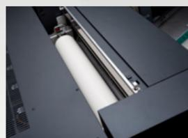
In der Primer-Einheit trägt im Hochqualitätsmodus eine Rasterwalze einen sehr dünnen Rapid Coagulation Primer-Film auf das Papier auf. Die Reaktion von Primer und der wässrigen Tinte ermöglicht eine hohe Detailwiedergabe und strahlende Bilder durch scharf definierte Punkte auf bestrichenem B2-Standardpapier.
